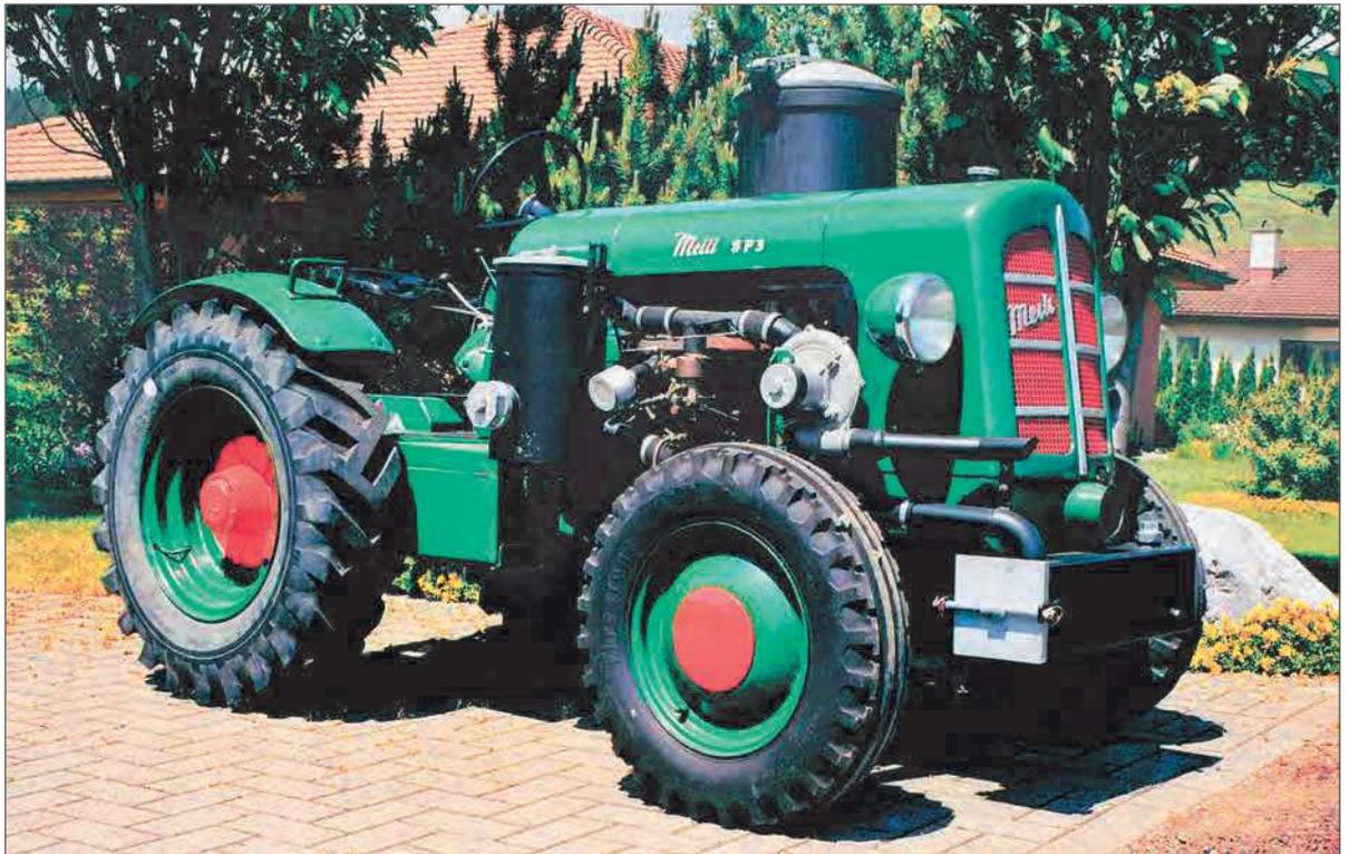
► Die neuen Traktoren verfügten bereits über ein selbst fabriziertes Ganzstahlrahmenchassis. Nur die Vorderachse, die Scheinwerfer und wenige Ersatzteile stammten noch von einem Automobil.
