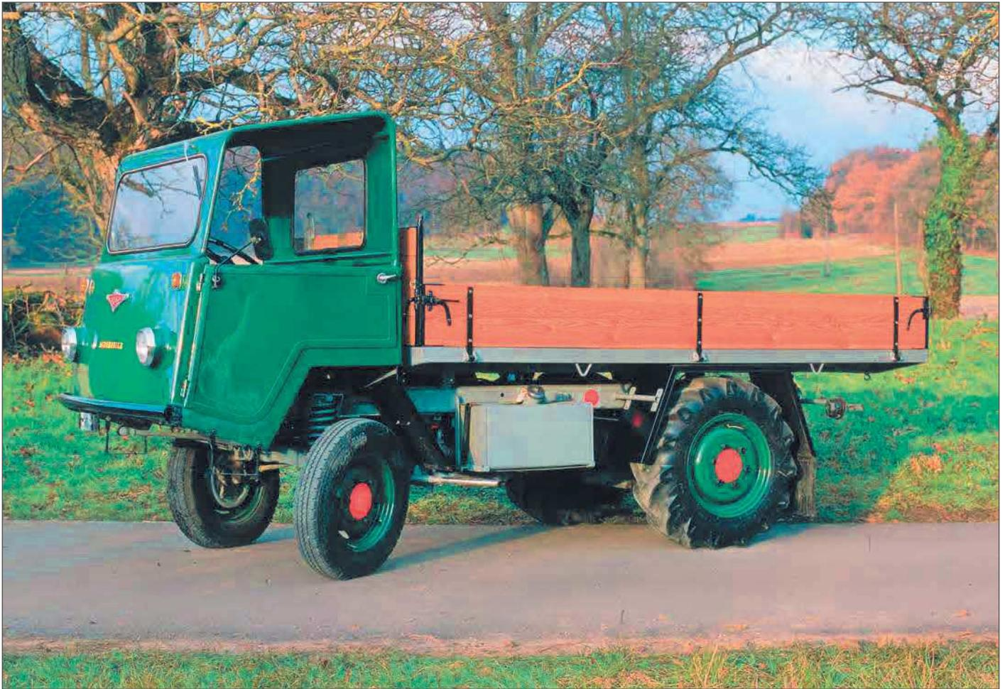
▲ Meili Agromobil A 2000 mit Jahrgang 1962, ausgerüstet mit einem 30 PS starken Vierzylinder-VW-Boxer-Motor.
